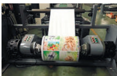
Беспиндельное устройство размотки (3 и 6 дюймов)
