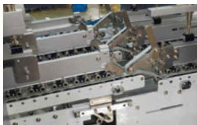
Устройство бескрючкового фальцевания передних клапанов (3 точки)
