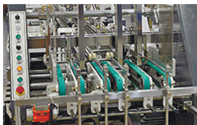
Секция подачи с вакуумными ремнями
