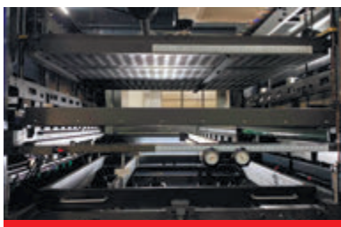
Секция удаления облоя
