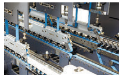
Секция фальцевания передних клапанов (3 точки склейки)
