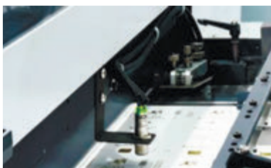
Ультразвуковой датчик контроля двойного листа
