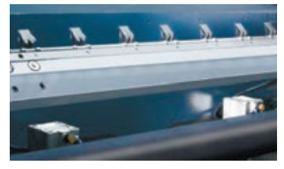
Карбоновый грейферный мост для снижения инерции
