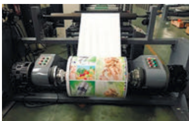
Безшпиндельное устройство размотки (3 и 6 дюймов)
