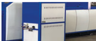
Масленная система нагрева ламинирующего вала
