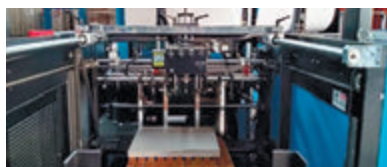
Высокоступельный самонаклад/приёмка (до 1300 мм)
