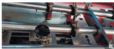
Механизм равнения листа с регулировкой нахлеста
