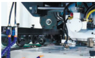
Усовершенствованная головка самонаклада (от 80 г/м 2 )
