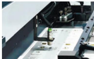
Ультразвуковой датчик контроля двойного листа
