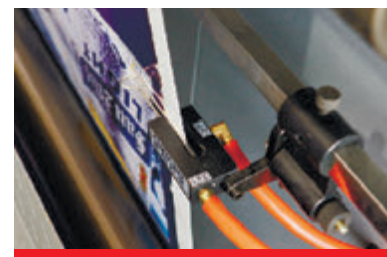
Высокоточное равнение кромки полотна с обратной связью
