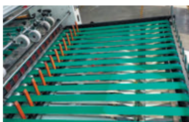
Приемный конвейер с функцией формирования пачки
