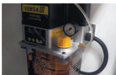
Автоматическая система смазки с индикатором уровня
