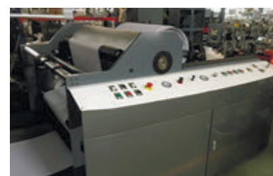
Секция намотки с контролем натяжения и датчиком обрыва полотна
