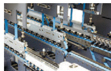
Секция фальцевания передних клапанов (3 точки склейки)
