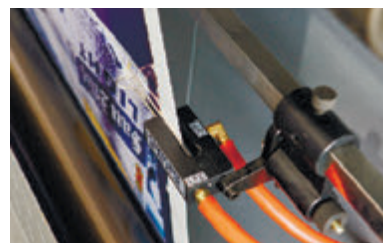
Высокоточное равнение кромки полотна с обратной связью
