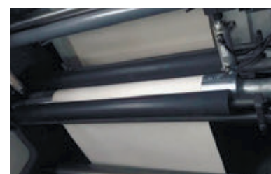
Автоматическая система контроля натяжения полотна
