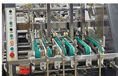
Секция подачи с вакуумными ремнями
