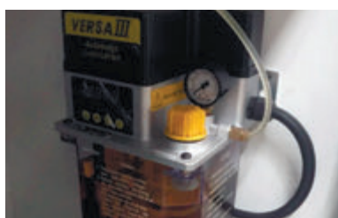
Автоматическая система смазки с индикатором уровня
