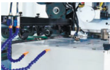
Усовершенствованная головка самонаклада (от 80 г/м²)
