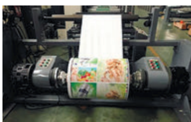
Безшпиндельное устройство размотки (3 и 6 дюймов)
