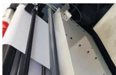
Сушильное устройство после каждой печатной секции
