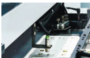
Ультразвуковой датчик контроля двойного листа
