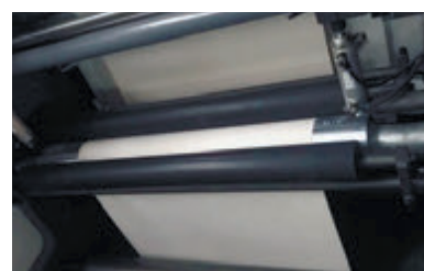
Автоматическая система контроля натяжения полотна
