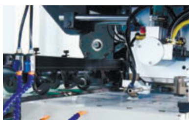
Усовершенствованная головка самонаклада (от 80 г/м 2 )
