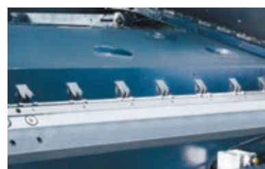
Карбоновый грейферный мост для снижения инерции
