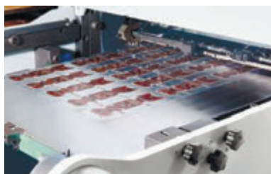
Наборная (4+1 мм) ответная плита с микроприводкой до 0,9 мм
