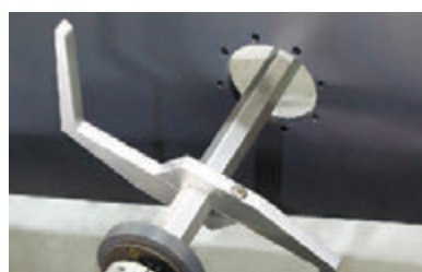
Устройство фальцевания задних клапанов (4/6 точек склейки)
