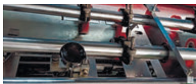
Механизм равнения листа с регулировкой нахлеста
