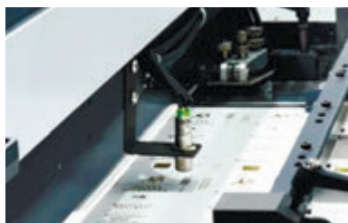
Ультразвуковой датчик контроля двойного листа
