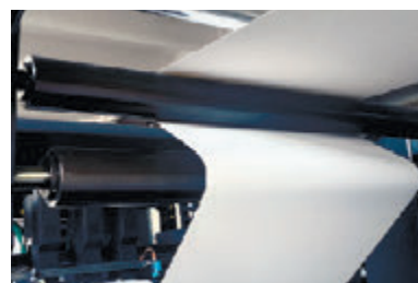
Система оперативного контроля натяжения полотна
