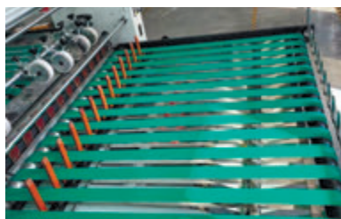
Приемный конвейер с функцией формирования пачки
