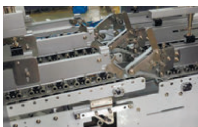
Устройство бескрючкового фальцевания передних клапанов (3 точки)
