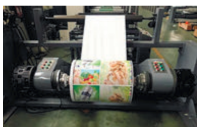
Безшпиндельное устройство размотки (3 и 6 дюймов)
