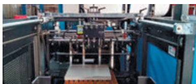
Высокостапельный самонаклад/приёмка (до 1300 мм)
