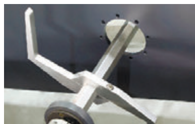
Устройство фальцевания задних клапанов (4/6 точек склейки)
