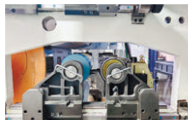
Закрепление валов без помощи инструментов
