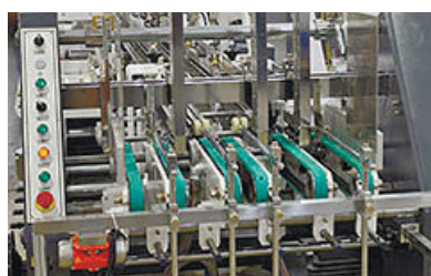
Секция подачи с вакуумными ремнями
