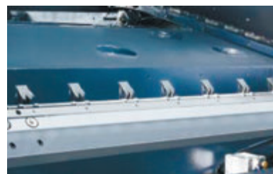
Карбоновый грейферный мост для снижения инерции
