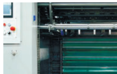
Автоматическая система нон-стоп со шторкой
