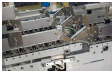
Устройство бескрючкового фальцевания передних клапанов (3 точки)
