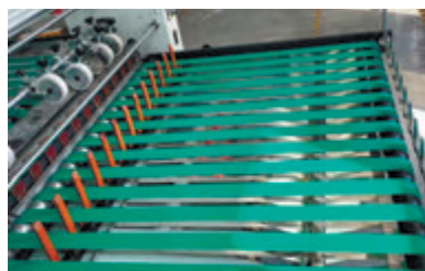
Приемный конвейер с функцией формирования пачки
