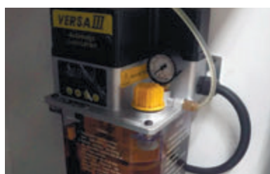
Автоматическая система смазки с индикатором уровня
