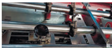
Механизм равнения листа с регулировкой нахлеста
