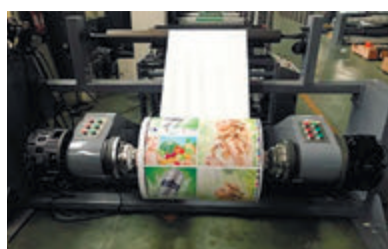
Бесшпиндельное устройство размотки (3 и 6 дюймов)
