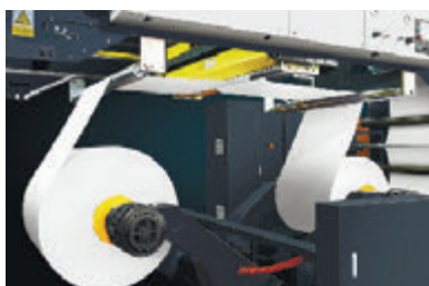
Устройство автоматической склейки полотна на ходу
