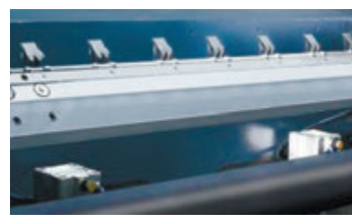
Карбоновый грейферный мост для снижения инерции
