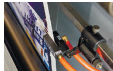
Высокоточное равнение кромки полотна с обратной связью
