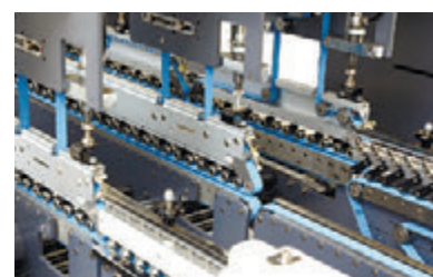
Секция фальцевания передних клапанов (3 точки склейки)
