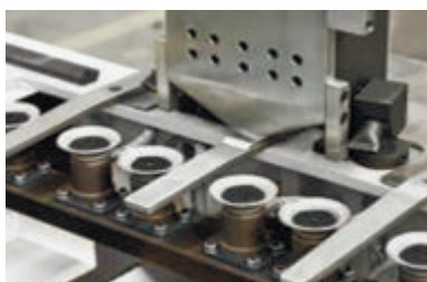
Безостановочный самонаклад с вакуумными присосками
