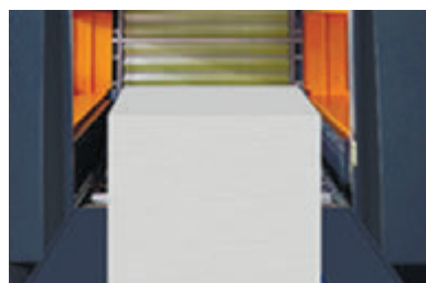
Устройство автоматического вывода паллетированной бумаги
