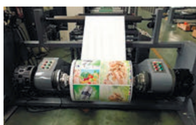
Бесшпиндельное устройство размотки (3 и 6 дюймов)
