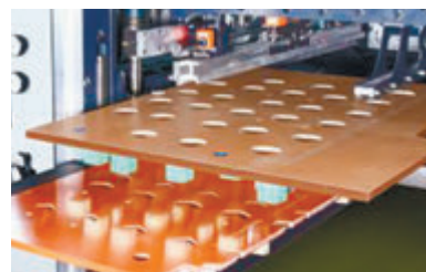
Устройство быстрой фиксации (зажимной инструмент)
