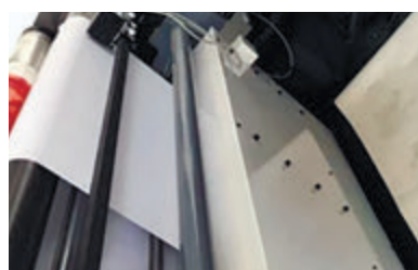
Сушильное устройство после каждой печатной секции
