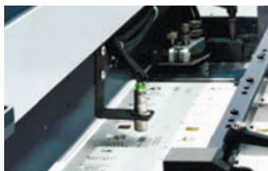
Ультразвуковой датчик контроля двойного листа
