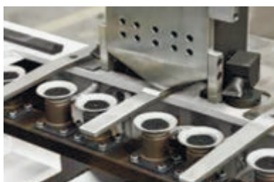
Безостановочный самонаклад с вакуумными присосками
