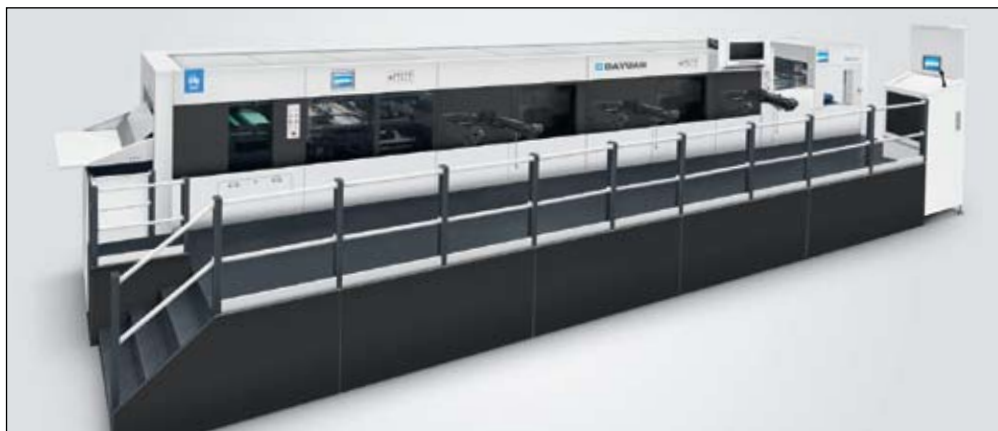
▼ Пресс ВНТ с тремя секциями под фиксированный процесс: фольга + конгрев + высечка + облой + разделение заготовок
